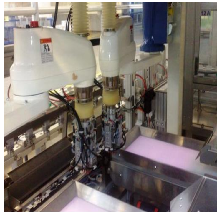
機器視覺整合機器手臂之自動化系統
