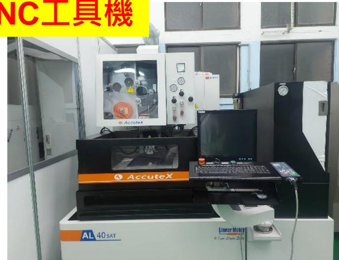
CNC線切割放電加工機
