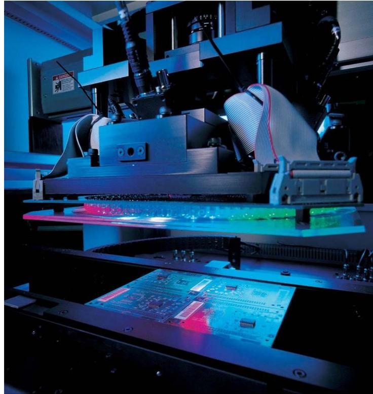
自動光電檢測(AOI)系統
