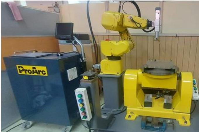
雷射銲接與機器手臂整合系統
