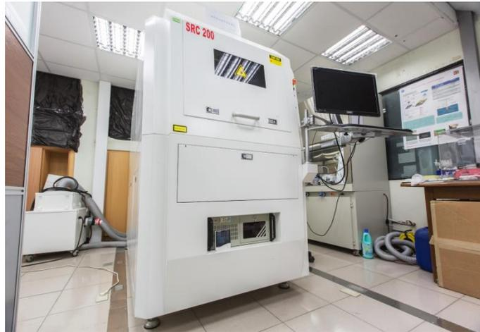
皮秒超快雷射加工系統
